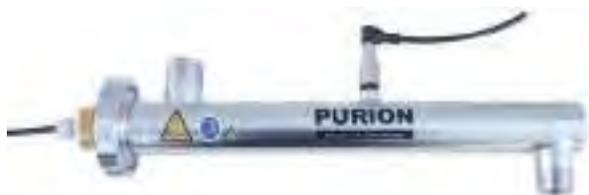
El equipo UV PURION 1000 H está hecho de acero inoxidable electrolítico 1.4571. El PURION 1000 H se aplica para desinfectar el agua potable hasta un caudal de 1.000 l /h y una transmisión del agua de al menos el 90% por cm.
