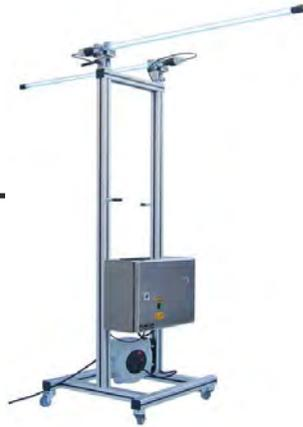
El AIRPURION mobile DUAL consta de dos lámparas PURION UV que se colocan en sistemas de tubos de inmersión de cuarzo. Las lámparas UV se ensamblan en un bastidor robusto y móvil. El móvil AIRPURION se puede encender y apagar a través del control remoto. El AIRPURION mobile DUAL es perfectamente adecuado para fines de desinfección en entornos de salas blancas existentes.
